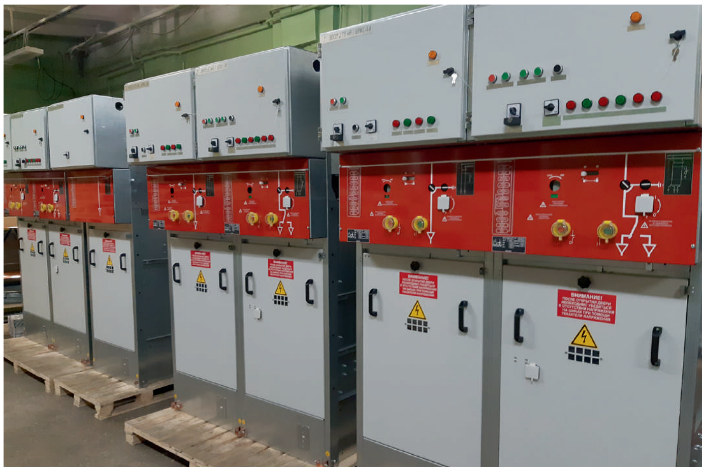
Детали окрашены порошковой эмалью
